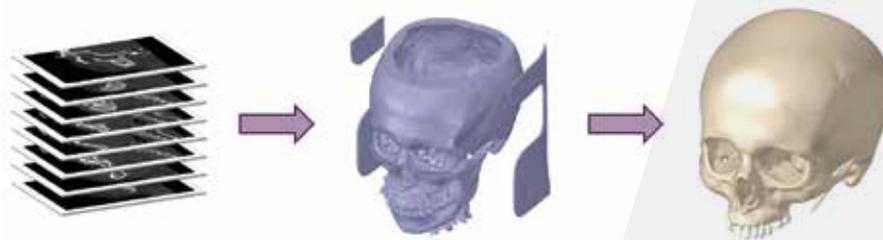
Методика моделирования от сегментирования результатов компьютерной томографии до обработки сеточной геометрии
