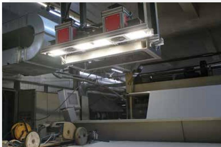
**Полное название проекта:** Разработка программно-аппаратного комплекса обнаружения и классификации дефектов тканей с использованием нейросетевых технологий
