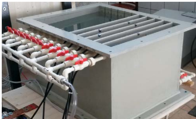
Ферратор, подключены 3 катодных и 2 анодных камеры
