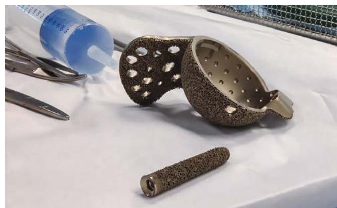
Ацетабулярный компонент кастомизированного титанового эндопротеза, произведенный с применением аддитивных технологий
