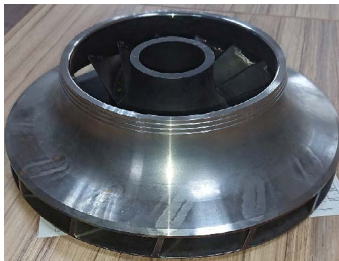
Рабочее колесо модельной ступени центробежного компрессора конструкции лаборатории МТПиПЭО Центра НТИ СПбПУ
