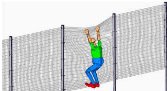
Цифровое моделирование для проведения антивандальной оценки конструкции ограждений
