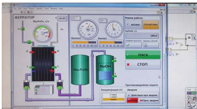
Операторская панель управления ферратором
