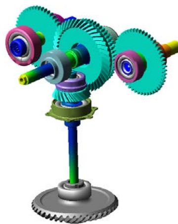
Динамическая модель коробки приводов с упругими корпусами и валами: поля перемещений, возникающих при резком приложении нагрузки
